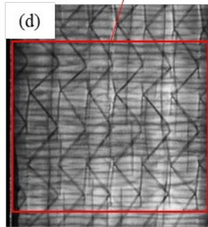
$-50^\circ\text{C}$ : (a) Undamaged stage, (b) 10% - 15% UTS, (c) 35% - 40% UTS, (d) 70% - 75% UTS.
