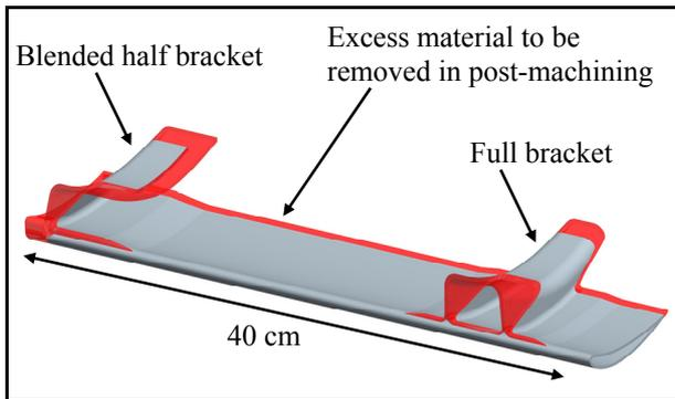
Fig. 9. Prototype slat
