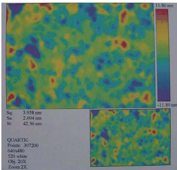
Fig. 5. HB-Cesic® Microroughness
