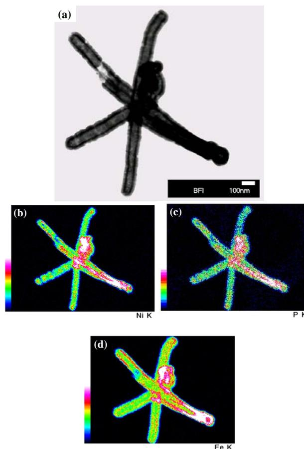
Fig. 7. (a) TEM BF image and (b), (c), (d) EDS map of Ni-Fe/CNFs
